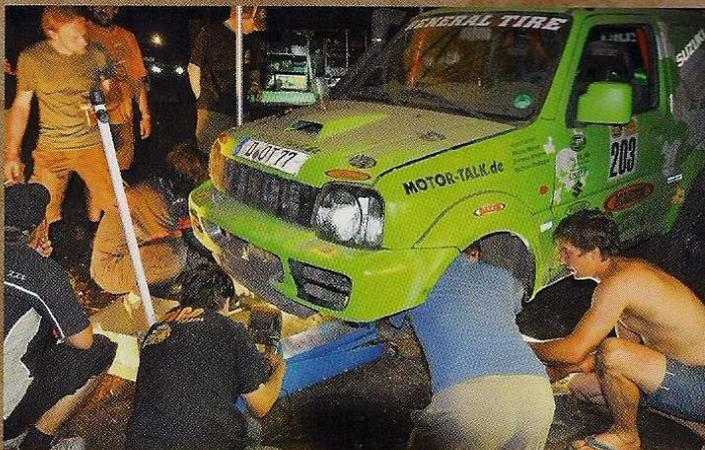
▲ Zeitintensiv: Die Reparatur der Vorderachse ist aufwändig. Durch einen Fahrfehler verbog sich der Achskörper.
